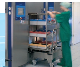
Übergabe des Einschubgestells in den Sterilisator mittels direkter Andockung
