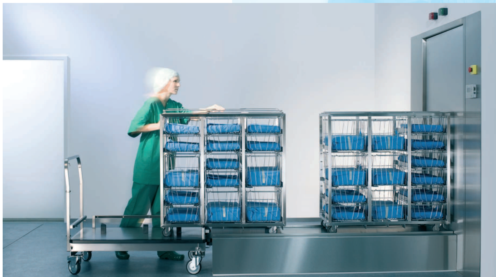
Bestückung eines bodenebenen Sterilisators
