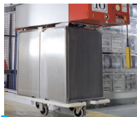
Automatischer Wagentransport (AWT), hängend mit Elektro-Hängebahn (EHB)
