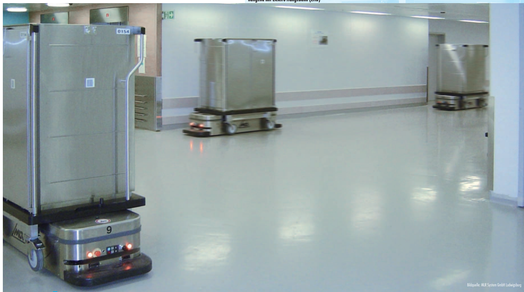
Automatischer Wagentransport, bodenfahrend mit Fahrerlosem Transportsystem (FTS)
