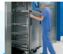
Einschieben eines Transportwagens in eine Waschanlage
